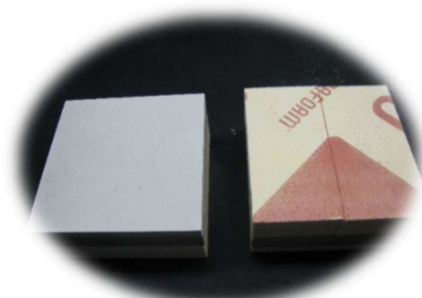
ロックウール吸音板が室内側
